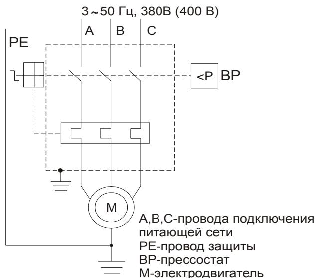
Рисунок А.1 - Схема электрическая принципиальная компрессора СБ4/Ф-500.LT100
