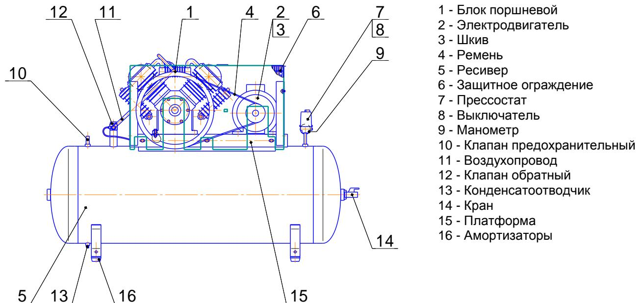
Рисунок 3 - Общий вид компрессора СБ4/Ф-500.LT100
